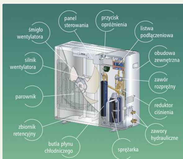
Ryc. 41 Rozmieszczenie elementów w module zewnętrznym
