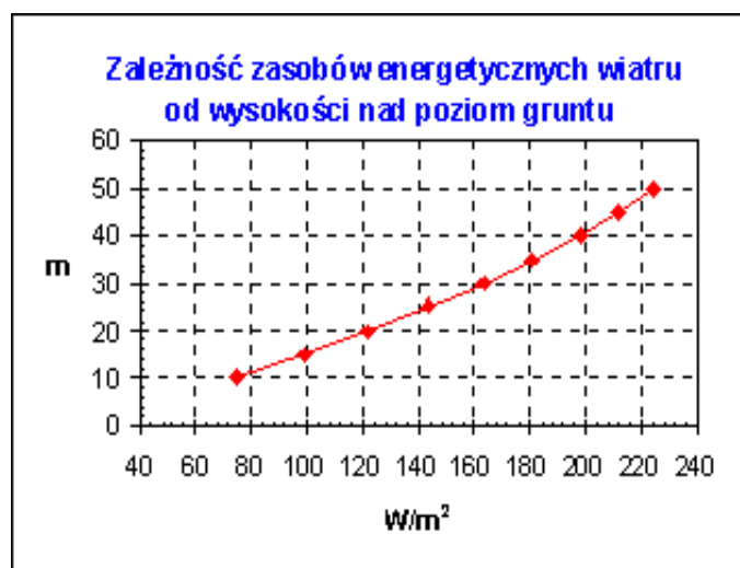
Ryc. 24 Wykres zależności energii wiatru od wysokości n. p. g.. Wielkość uzyskanej energii rośnie ze wzrostem wysokości siłowni wiatrowej, ten parametr ma swoje ograniczenia konstrukcyjne. źródło; IMGW
